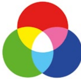
RGB – Bildschirm Additive Farbmischung
